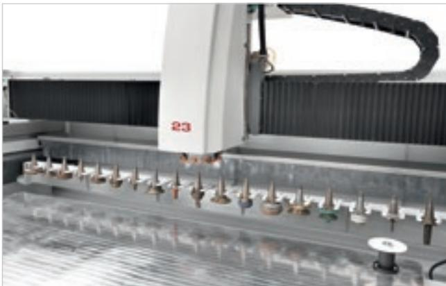
Changement d'outil arrière avec carter de protection contre les résidus de façonnage pour les cônes à 18 positions et chargement automatique de l'outil avec le groupe opérateur.
