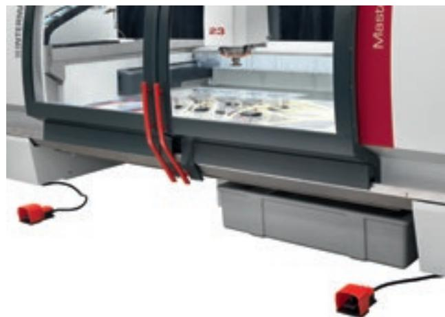
Système rapide de blocage de pièce avec vide grâce à la double pédale de série sur la machine.
